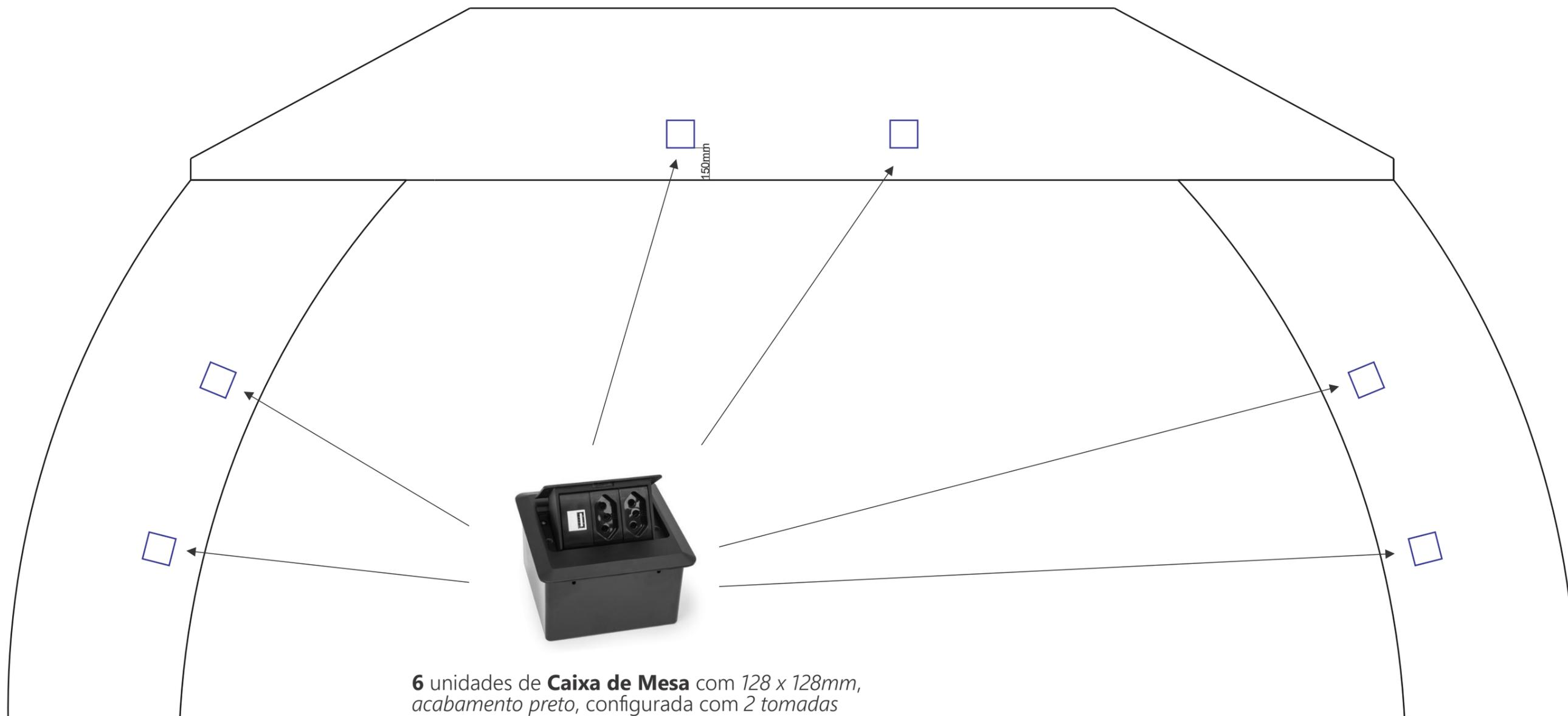
**6** unidades de **Caixa de Mesa** com  $128 \times 128\text{mm}$ , acabamento preto, configurada com 2 tomadas elétricas 10A + 1 USB Charger 5V 2.1A. Embutidas ao granito conforme desenho acima, exatamente alinhadas a cima de cada Suporte Mão Francesa.
