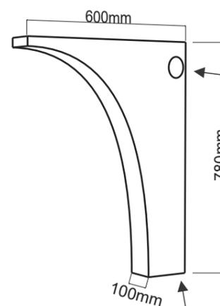
Furação de acesso a Calha. Calha com largura de 10cm cobrindo toda a extensão da mesa, com finalidade de passagem de cabos.
