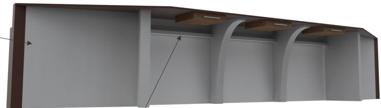
**Calha**, com largura de 10cm cobrindo toda a extensão da mesa, com finalidade de passagem de cabos de microfones e energia
