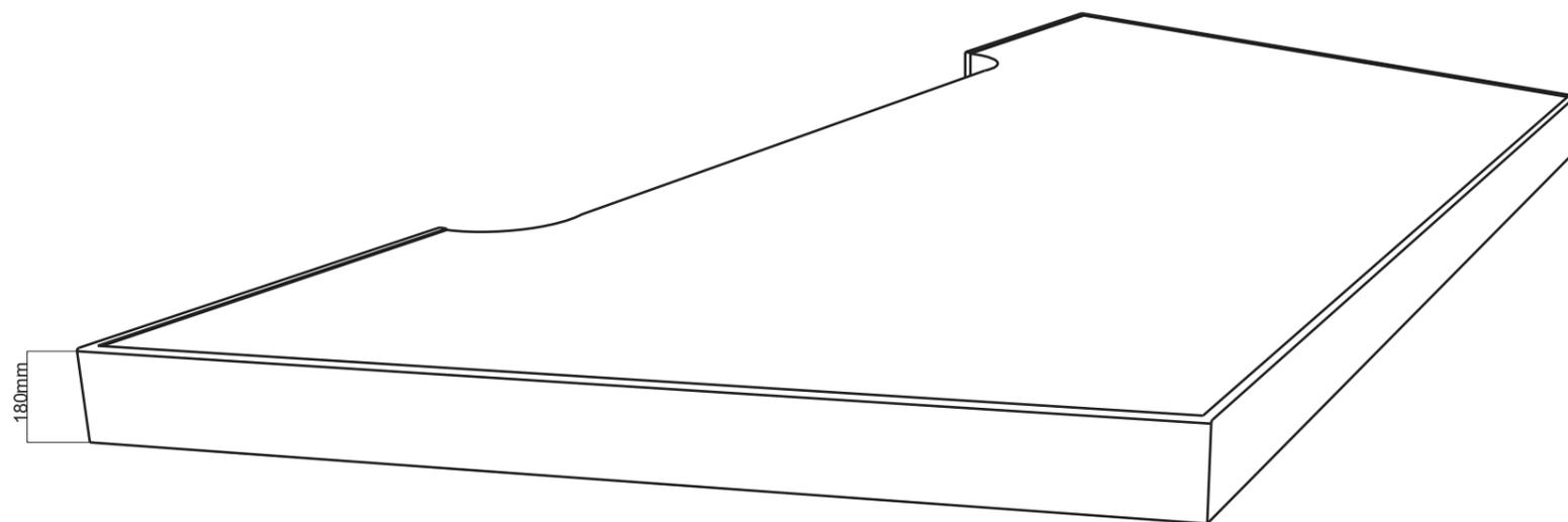
**Relevo** nas bordas laterais do Tablado para que impeça que os rodízios das cadeiras ultrapassem os limites do tablado.
