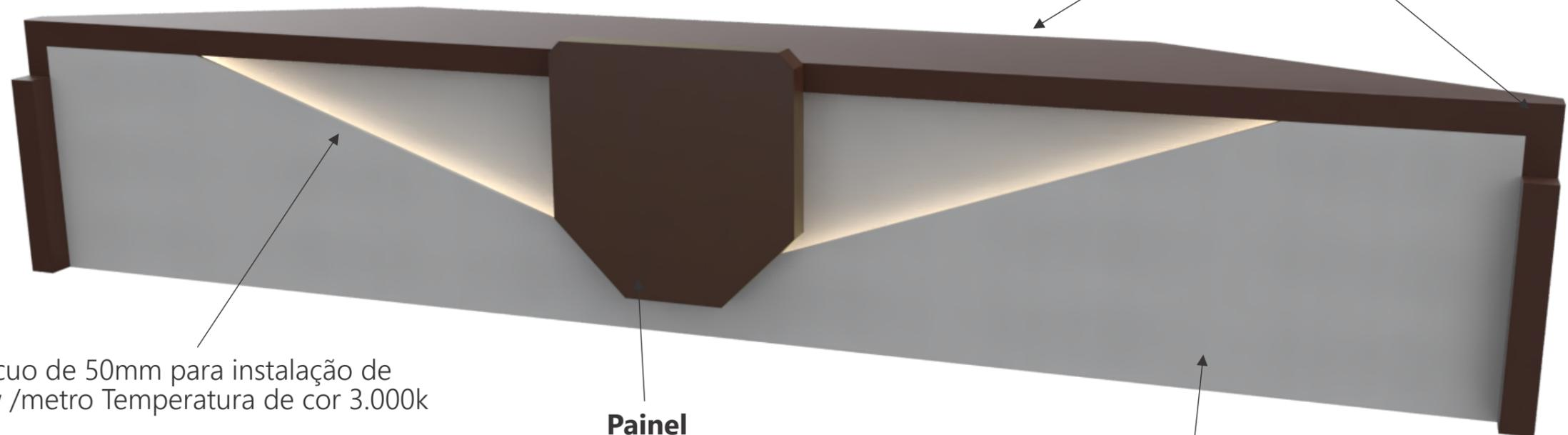
**Iluminação** Recuo de 50mm para instalação de fita de LED 4.8w /metro Temperatura de cor 3.000k
